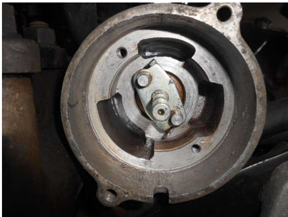
図1、コンタクトブレーカープレート、カムガバナウエイト等を取外した状態
