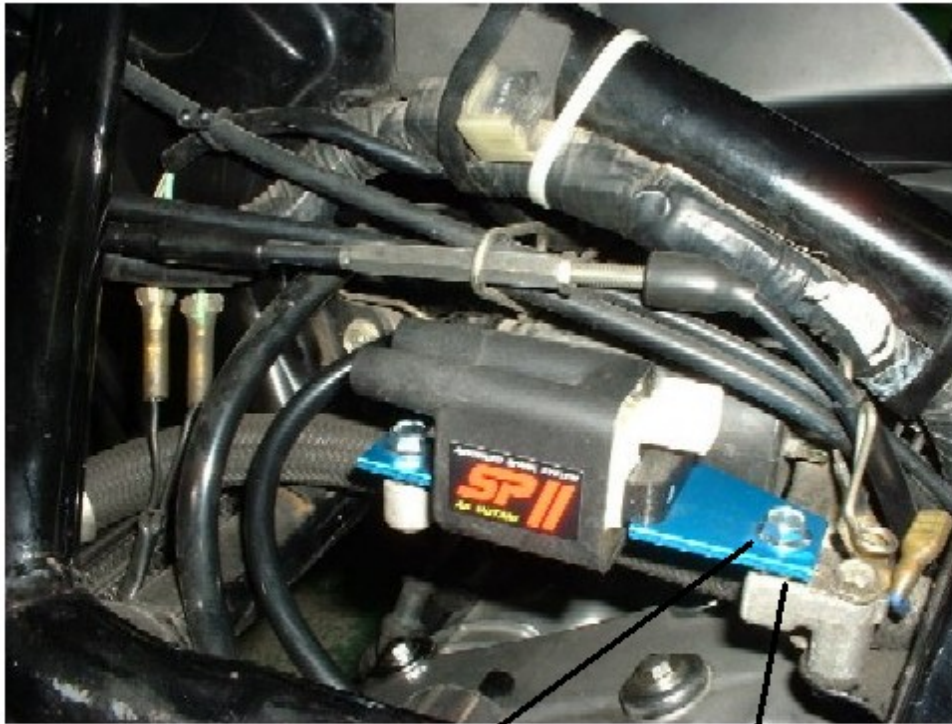
図 1 SP2 コイルの取付け
