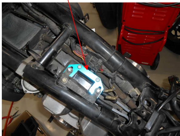
図6、図7、SP II イグニッションコイルの取付け
