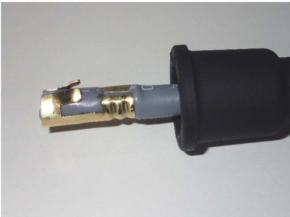
3、コネクタ金具を被せ、後部をカシめる。カシメ工具がないときは、ラジオペンチ、プライヤなどなるべく小さく丸める。金具の先端はやや開いておく。
