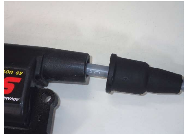
4、コネクタ金具が見えなくなるまで(コイル穴底部まで)コイルに押し込む。
