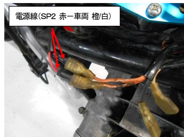
図6、電源線の接続
