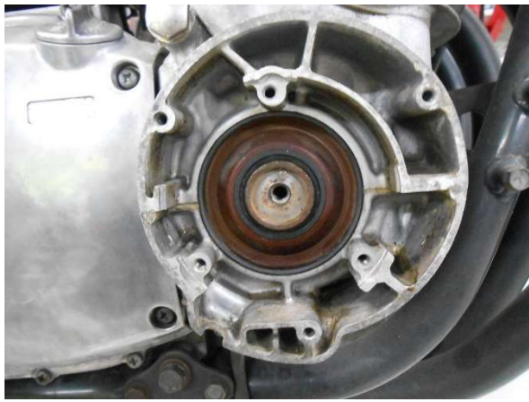
図1、ポイント／ガバナを外した状態
