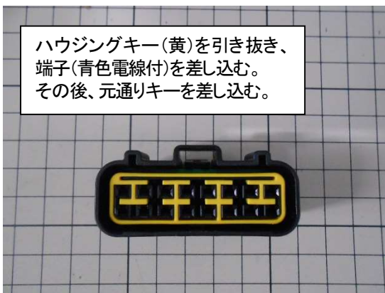
図8、SP2コントロールユニット、電気式タコメーター(社外)用出力線(12Vデジタル、1パルス/回転)
