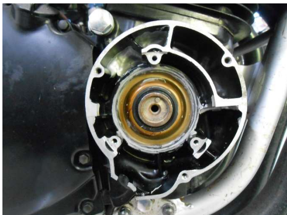
図1、ポイント／ガバナを外した状態
