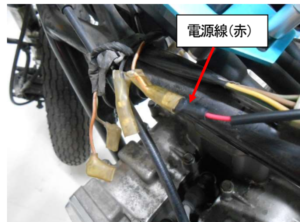
図6、電源線の接続
