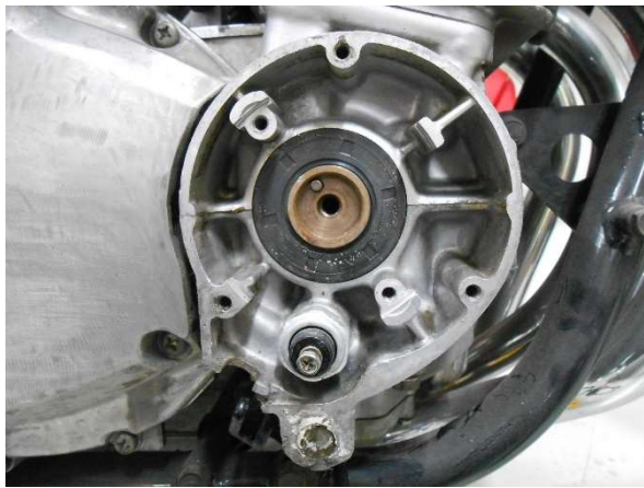
図1、ポイント／ガバナを外した状態
