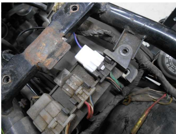
図5、オイルプレッシャースイッチ接続コネクタの装着
