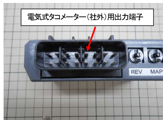
図8、SP2コントロールユニット、電気式タコメーター(社外)用出力線(12Vデジタル、1パルス/回転)
