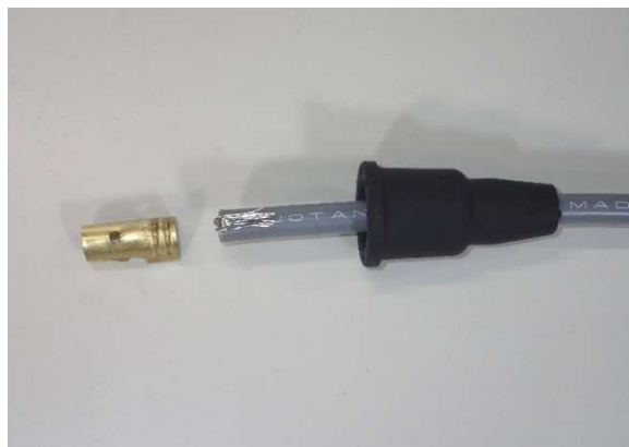
2、ブーツをコードに被せ芯線を折り返す。
