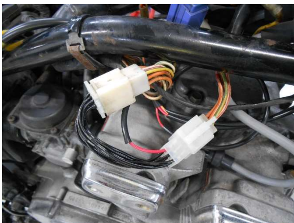
図5、電源取出し割込みコネクタの装着
