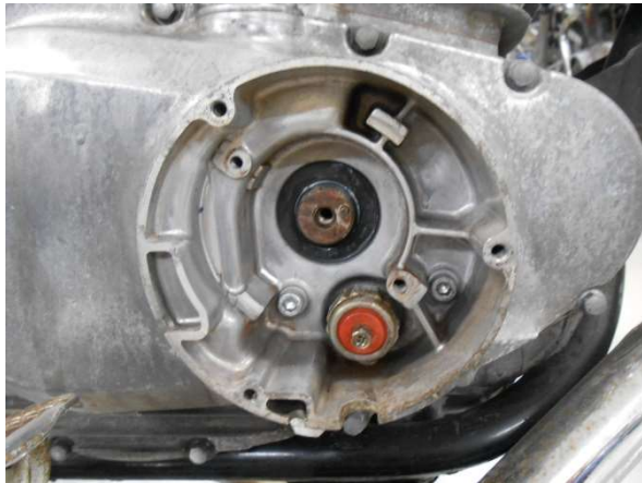
図1、ポイント／ガバナを外した状態にしてSP2ピックアップASSYを取付ける
