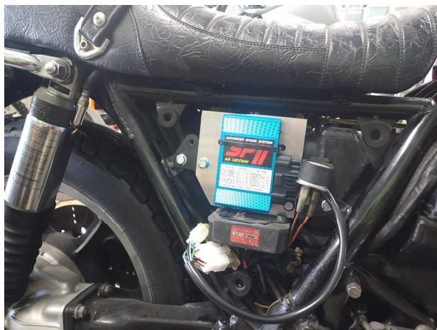
図2 SP IIコントロールユニットの取付
