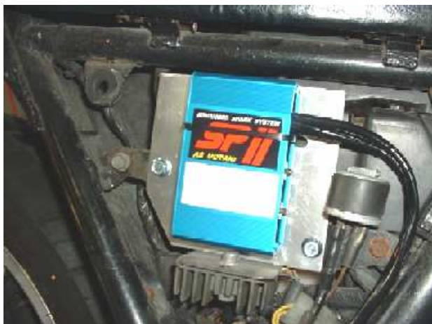
図1 SP II コントロールユニットの取付
