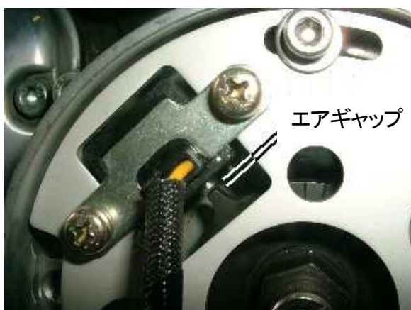
図5、エアギャップを0.4~0.6mmに 合わせる
