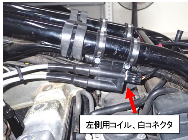
図6、フレームの下に回し固定する
