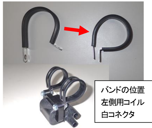
図4、コイルバンドの形を整える
