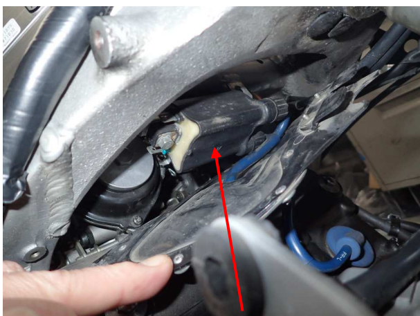
図1、フロントシリンダ(2・4)用ノーマルコイル
