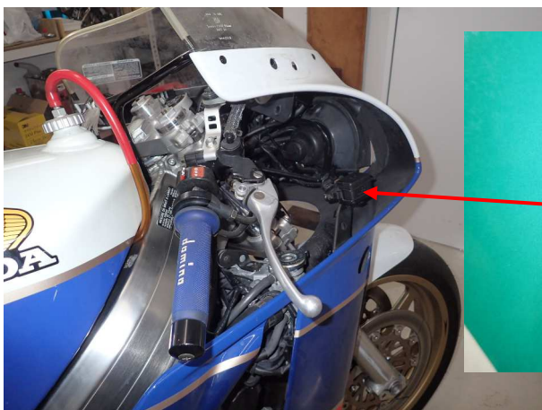
図5、イグニッションヒューズ(ST. IGN)を15Aに交換
