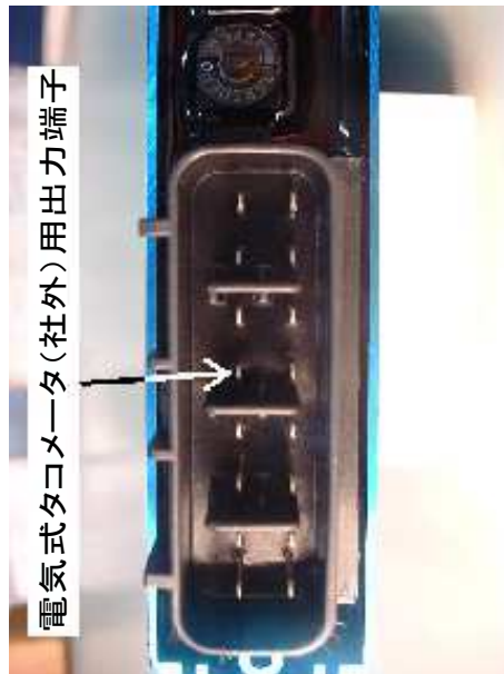
図8、SP IIコントロールユニット、電気式タコメータ(社外)用出力線(12Vデジタル、1パルス/回転)
