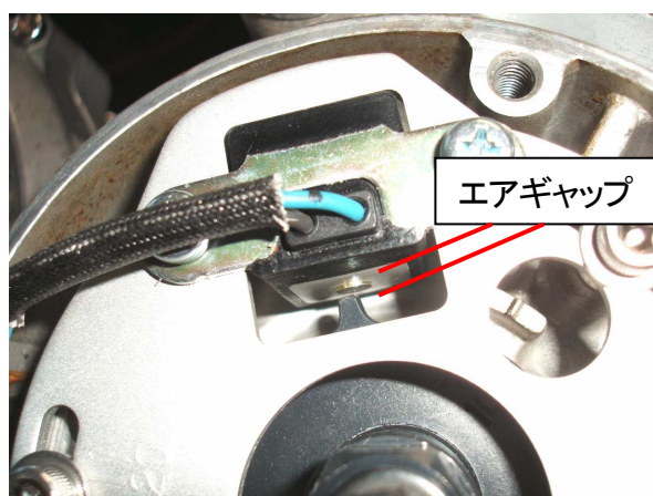
図5、エアギャップを0.4~0.6mmに 合わせる
