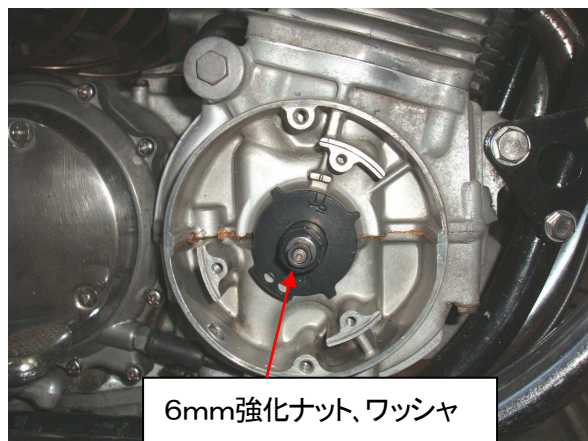
図2、SP II タイミングロータの取り付け
