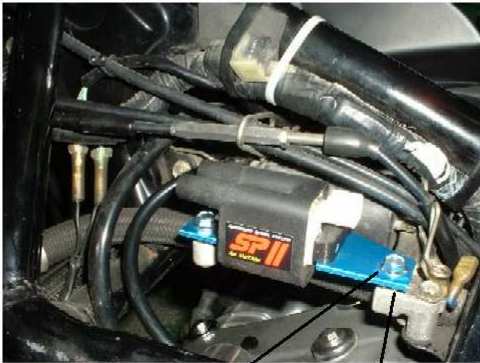
図 4 SP II コイルの取付け
