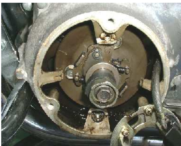
図1 SP II ロータの取付
