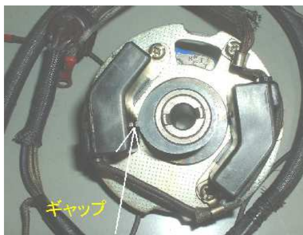
図2 エアギャップの確認、調整
