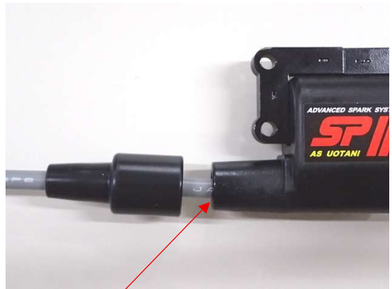
4、6mmの印まで (コイル穴底部まで) コイルに押し込む。
