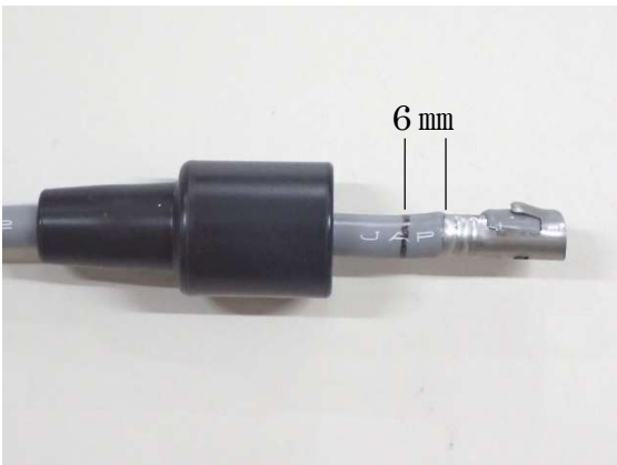
3、コネクタ金具圧着部から6mmのところ にマジック等で印をつける。
