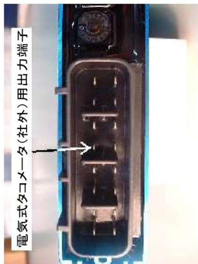
図9、SP2コントロールユニット、電気式タコメータ(社外)用出力線(12Vデジタル、1パルス/回転)
