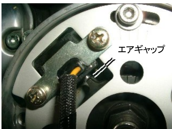
図5、エアギャップを0.4~0.6mmに 合わせる
