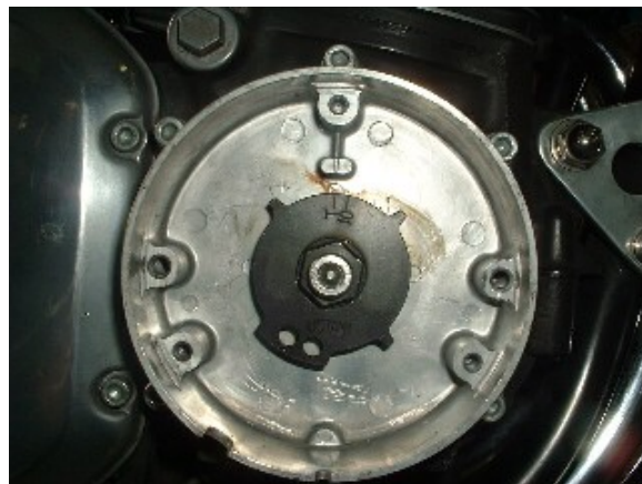
図2、SP2 タイミングロータの取り付け
