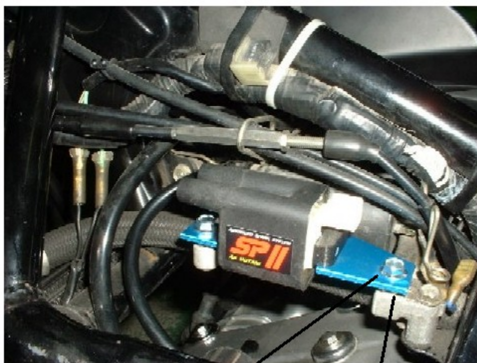
図 1 SP2 コイルの取付け
