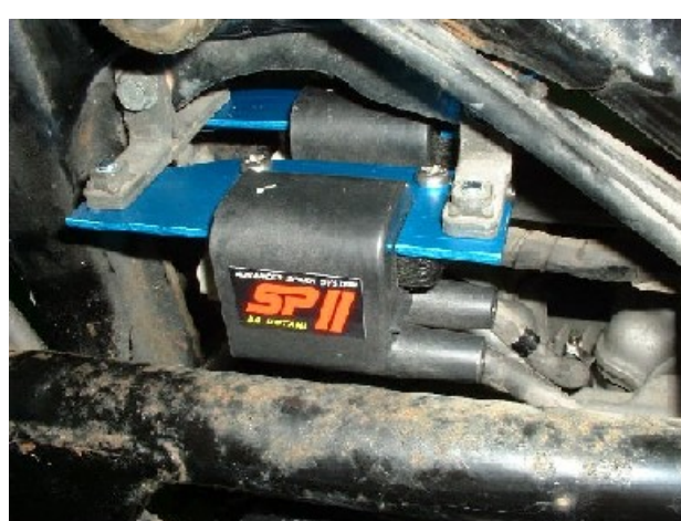
図6 SP2 イグニッションコイルの取付
